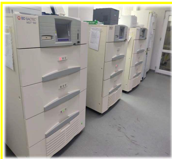
სურათი 2. BACTEC MGIT 960 სისტემა
